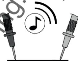
След това свържете измервателните контакти с измервания обект. Като проходимост се счита измерена стойност  $< 30 \text{ Ohm}$ , която се потвърждава с акустичен сигнал. Ако на дисплея не се появи стойност от измерването, а „O.L“, или обхватът на измерване е превишен, или измервателният контур не е затворен или е прекъснат.
